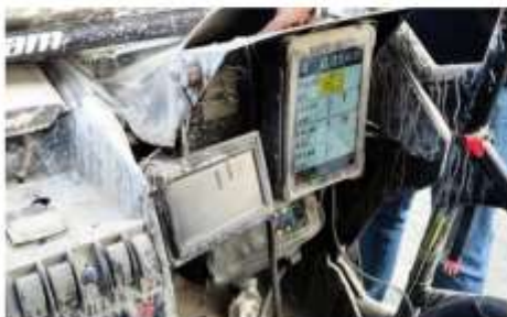
Instalación equipo CapRoad con soporte en el salpicadero con silentblock/tornillos.
